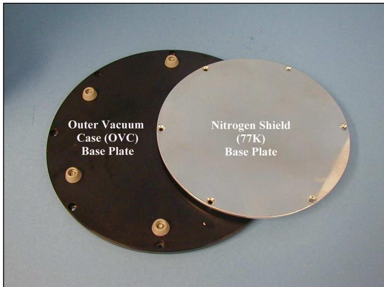
**Photo 1.3.** Cryostat base-plates
